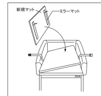
④交換用マット (新規ミラーマット付) ミラーマット裏紙を剥がし、速乾ボンドをマット側・本体側両方に塗布し、取り付けてください。
