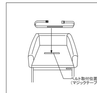
③キャッチ式ベルトを取り付け、本体の両端に出してください。
