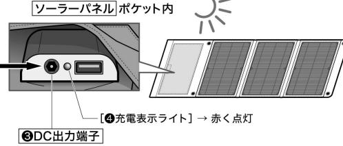
曇りの日や夕方等、太陽光の照度(強さ)が弱いと、「ソーラーパネル」の出力が不十分となり、「メガパワーバンク」の充電に必要な電力量に満たないため「メガパワーバンク」が充電状態にならず、電池残量表示が消灯したり、早い点滅状態になります。ソーラーパネルによる充電は、十分な太陽光のある環境下で行って下さい。
