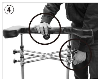
アームレストの中心上側からカチッと音がするまで押さえつけると、アームレストにロックがかかります。左右のクロスバー固定ノブボルトを確実に締め付けてください。
