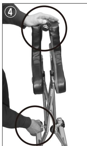
④ アームレストが完全に閉じたらロックボタンがカチッと音がしてロックがかかります。左右のクロスバー固定ノブボルトをしっかりと締め付けてください。
