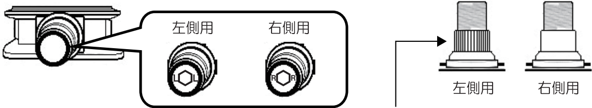
ペダル軸にきざみがあるのが左側用ペダル
