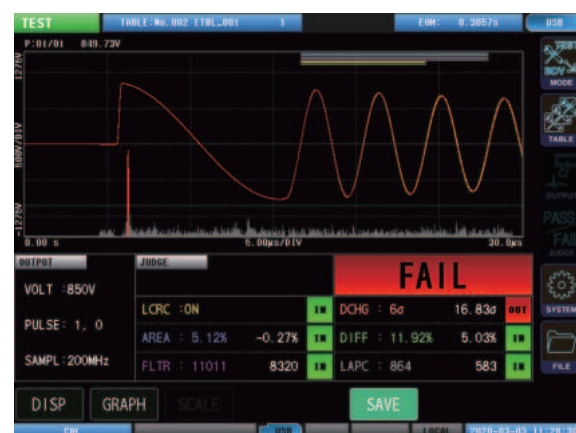
図 7 波形グラフ表示画面（放電あり）
