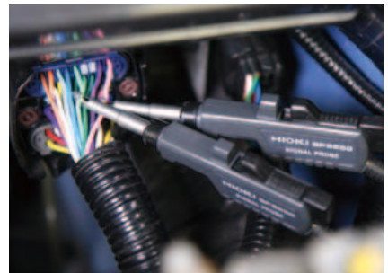
ケーブルを傷めず簡単、安全に測定
