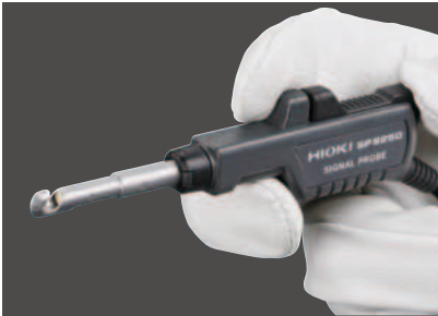
片手操作でセンサー先端部を開く
