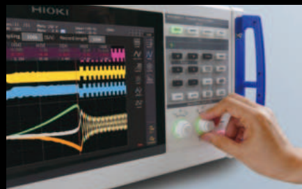
直感的なノブ操作で、波形の表示位置、 トリガーや高調波次数を調整
