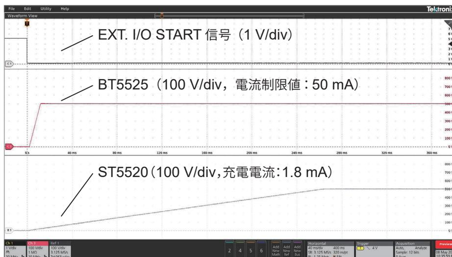
図5 BT5525 と ST5520 の試験開始時の試験電圧波形
