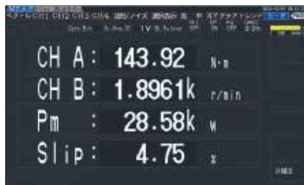
モータ解析画面 (トルク、回転数、モータパワー、すべり) CH B にエンコーダの Z 相パルスをを入力すると電気角、B 相パルスをを入力すると回転方向を測定できます
