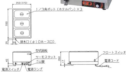
注、( )は浮止め取付時の寸法を表します。
