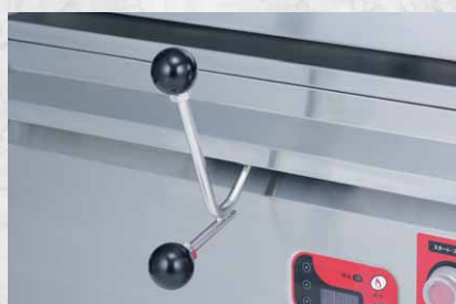
■上下2又に分かれており、手でも膝でも操作できる火力調整レバー
