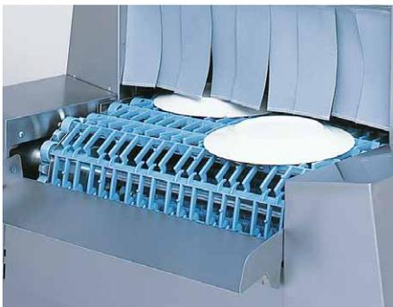
万一食器が挟まった場合でも、センサーが感知してシュートリミットを作動させ、洗浄機の運転を自動で停止します。食器の破損やネットの損傷を防ぎ、安全に作業できます。また、洗浄室内でシルバー等が引っ掛かった場合も安全装置が作動して、コンベアの破損を防ぎます。
