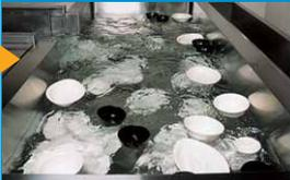
かき上げ槽での浸漬効果と噴流ポンプによる水流で汚れを落ちやすくします。噴流ポンプの水流により、食器はコンベア部に集められます。ゴミは噴流ポンプ前のゴミ受けに集まるので、清掃もラクに行えます。
