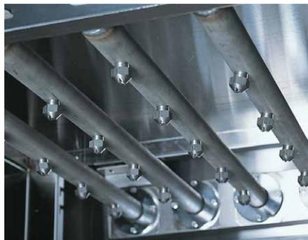
マルゼン独自の高流量ノズルから噴射される洗浄水が、油などのガンコな汚れも確実に洗い落とします。また、洗浄ノズル、すすぎノズル、ストレーナー（ごみ受け）などのパーツは工具なしで取り外し可能。毎日のお手入れが簡単にでき、衛生的に保てます。
