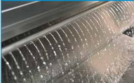
下膳時に汚れを予めシャワーシンクで落としてから食器をかき上げ槽に投入してもらいます。箸やシルバー類、φ55mm以下の小食器は専用カゴに入れてもらいます。残渣が多く出る場合は、ダストテーブルを用意することをお勧めします。
