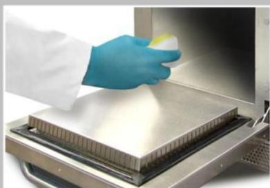
機器内部の面に、焦げ付き防止剤を軽くのばします。
