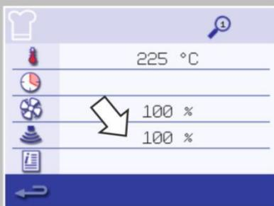
「マイクロウェーブ」のマークを選択します。キーパッドを使って、マイクロウェーブの出力を設定します（0および5～100%）。緑色のチェックマークを選択して、入力した値を保存します。
