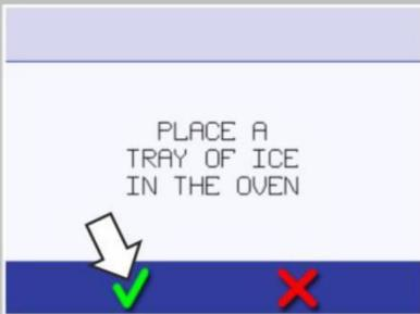
必要なすべての対策を取って、適切なアイスキューブのトレイを高温の調理庫内に入れます。これにより、冷却プロセスが加速します。緑色のチェックマークを押して、次に進みます。
