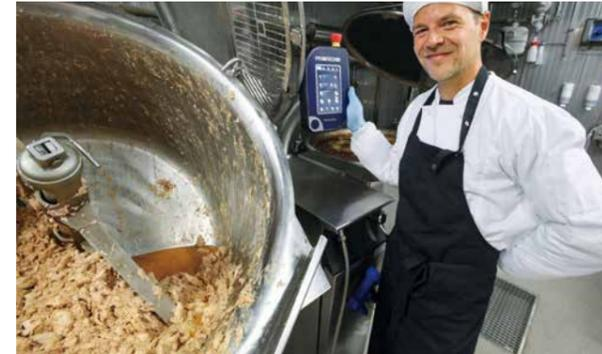
攪拌時間や温度は、タッチパネルで簡単操作。スピードタイマー機能もあり、すべて自動で攪拌します。傾けながら攪拌が可能です。
