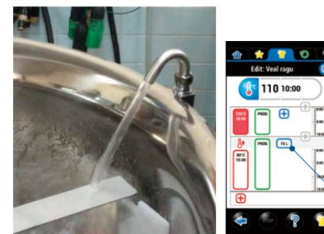
ジャケット内、ケトル内も自動で給水します。設定しておけば、調理中も自動で給水可能で、重労働を軽減し、水を測る手間も省けます！もちろん、手動で水を入れることもできます。
