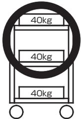
床面は平坦なコンクリートでツールワゴン1台あたりの均等耐荷重を棚板の枚数で割った重量を上限に各段均等にお載せ下さい。
