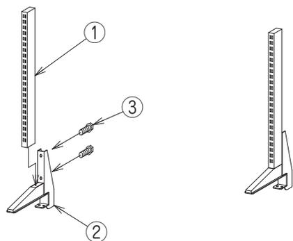
ロ. 組み上がった支柱を右図の天板組付詳細を基に、天板に取り付けます。後ほど取り付ける⑥棚板や⑦パネルの幅に合わせて支柱を天板に取り付けて下さい。
