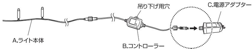
※B.コントローラーは、吊り下げ用穴にフックやヒモなど(お客様手配)を取り付けて、壁面等に固定してください。
