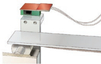
冷蔵庫内光電センサー霜取り用
