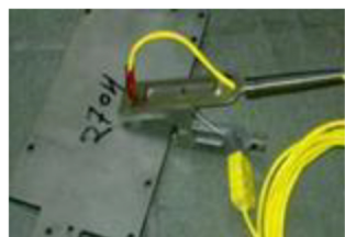
クリップ表面 温度センサ
