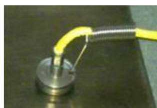
磁石表面 温度センサ
