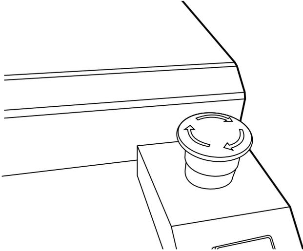
上から**強く押し込む**と動作が停止します。状況を回復した後、本体に記された**矢印の方向**にひねると、再び動き出します。
