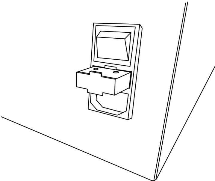
1. 本体側面の**スイッチと電源の間**にあるヒューズ入れを手前に引き出します。
