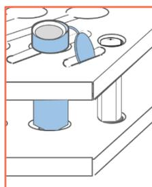
3. マイクロチューブが正しく整列していることを確認し、分注機にセットします。
