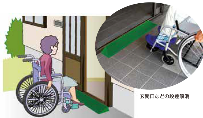
屋外での段差解消
