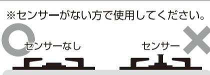
※全てのバーナーにセンサーがある機種は、センサーを解除して（高温炒めモード）使用してください。ご使用の際は、機種の取扱説明書にそって正しく使用してください。
