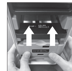
②大気センサーカバーを上スライドさせるとカバーが外れます。
