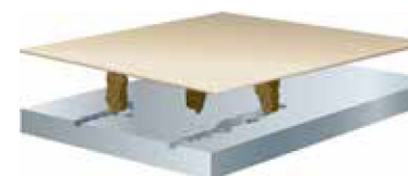
切れ味を失い目詰まりが発生
