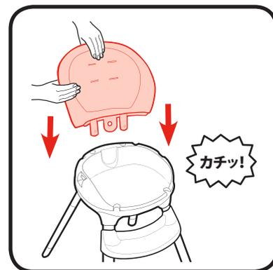
5.シートバックの2本の支柱をシートの穴に合わせて差し込みます。
