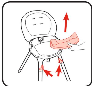
1.図のようにフットレスト両脇のタブを内側に引きながらフットレストを引き上げ、取り外します。
