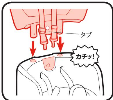
4.シートバックを取り付けるには、2本の支柱をシート本体の穴に合わせて差し込み、タブの穴をシート本体の突起にはめ込みます。
