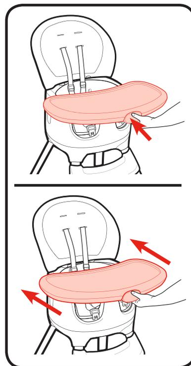
1.トレイの前面にあるボタンを押しながら、シートに向かって押して、トレイの位置を調節します。位置は3段階に調節出来ます。位置の調節は、もう片方の手でシート本体をおさえながら、ゆっくりと調節してください。
