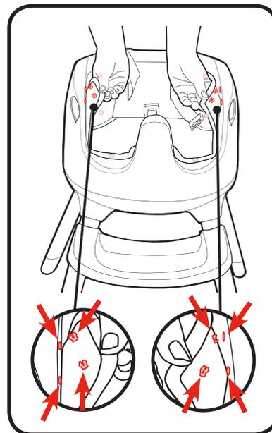
2.シートボトムパッドを取り外すには、10カ所のプラスチックタブを外します。
