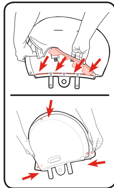
4.図のように、シートバックにシートバックパッドのプラスチックタブ(4カ所)を取り付けて、スナップ(3カ所)を固定してください。
