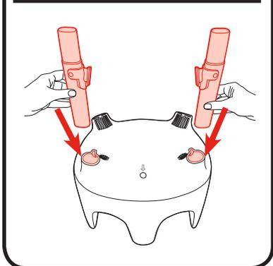
プラスチック製のコネクタが、図のように内側に向き合うようにして取り付けてください。
