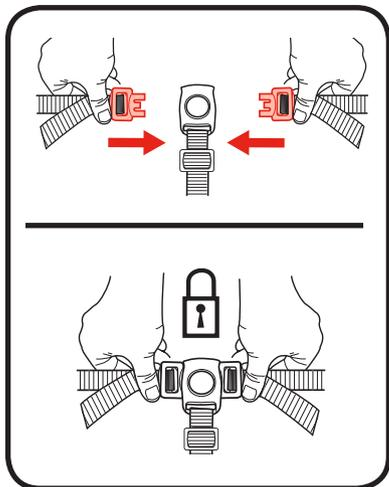
1.図のように腰ベルトをベルトバックルに取り付けます。
