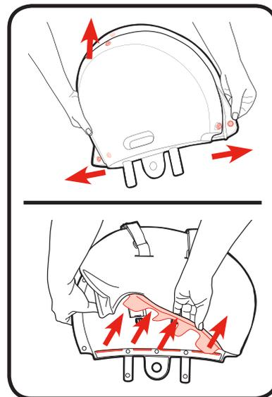
1.シートバックパッドを取り外すには、背面の3カ所のスナップを外し、前面の4カ所のプラスチックタブを外します。
