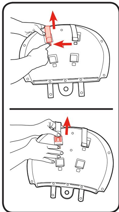
肩ベルト取り付け穴の下にあるボタンを押して、肩ベルトを取り付け穴から引き抜きます。
