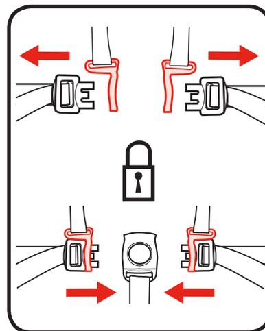
2. 閉じる時は、肩ベルトコネクタを腰ベルトに取り付けて、バックルへはめ込んでください。
