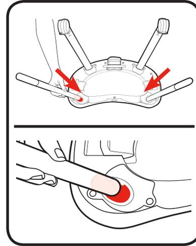
4.リアレッグの取り付け穴に、下部リアレッグパイプ(車輪無し)を取り付けます。
