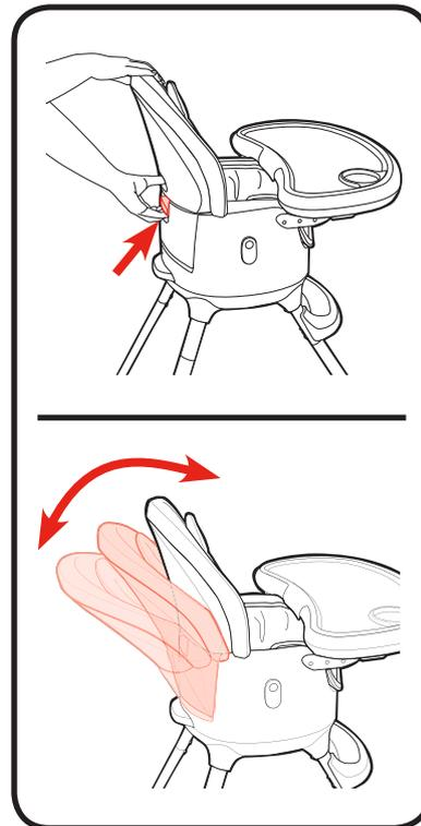
1. シートの後ろ側のハンドルを握ってシートバックを上げ下げし、リクライニングの調節をします。
