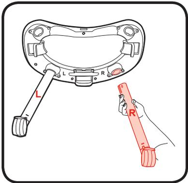
3.フロントレッグの取り付け穴に下部フロントレッグパイプ(車輪付き)を取り付けます。トレイの底面の「L」と「R」がフロントレッグパイプの「L」と「R」と合っていることを確認してください。
