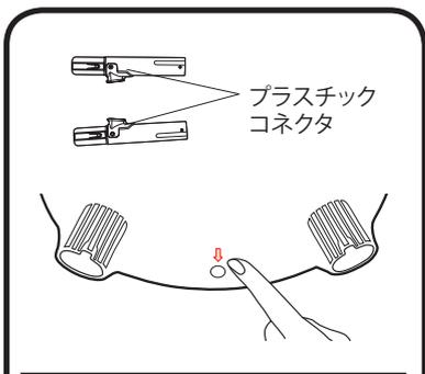
2.シートの底部にある矢印マークを確認してください。上部フロントレッグパイプ(プラスチックコネクタ付き)を矢印マークの両脇の穴に取り付けます。
