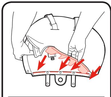
4. シートバックパッドをシートバックにかぶせ、肩ベルトをシートバックパッドの対応する穴に挿入します。
