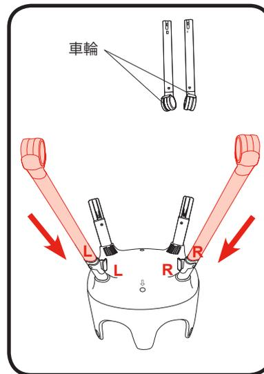
4.パイプに表示されている「L」と「R」がシートの底部の「L」と「R」に合っていることを確認して、下部フロントレッグパイプ(車輪付き)を上部フロントレッグパイプ(プラスチックコネクタ付き)に取り付けます。
