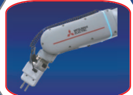
エア配管を接続
