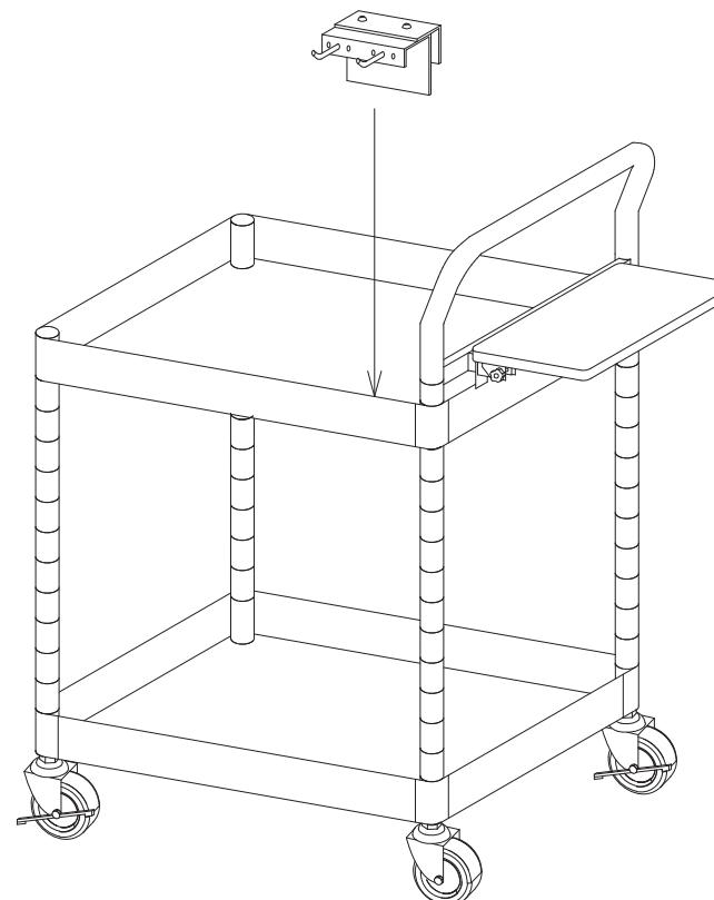
**C** ①フック本体と②フック取付板で棚板を強く挟み込み、③トラス小ネジ④セレイト付フランジナットでしっかりと固定します。
