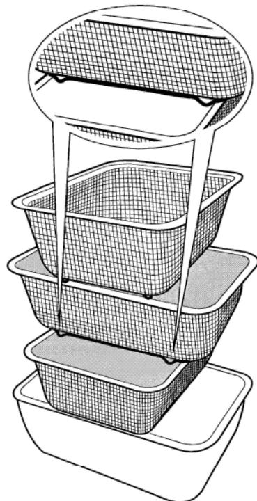
※左図のように溝に合わせて固定しクロスに積み重ねて使用できます。
