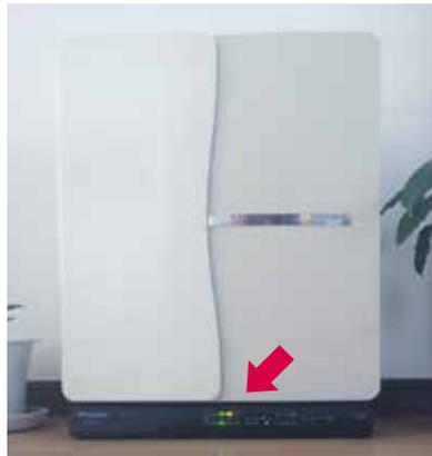
●電解器 J515 起動 5 分後黄ランプが点灯。電解 10 分停止の場合、～20 分後に消えます。
