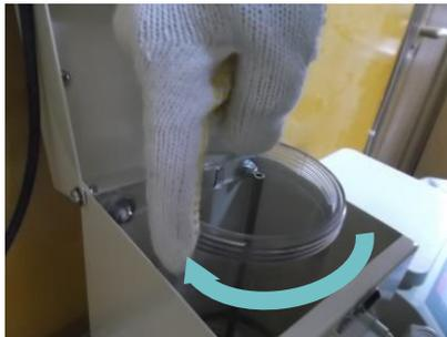
研削材タンク(②)の上面やネジ部に付着した研削材を取り除いて下さい。
