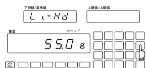
重量表示画面において、設定したい上限幅を数値キーで入力して、[上限セット] キーを押します。
