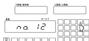
重量表示画面で、[メモリ呼出し] キーを押すと、現在使用しているメモリ番地がメイン LCD に一時表示されます。
