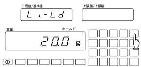
重量表示画面において、設定したい下限幅を数値キーで入力して、[下限セット] キーを押します。
