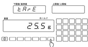
[風袋引  $\rightarrow$ tArE] キーを押すと、左側サブ LCD に < tArE > が表示されピーツ♪とブザーが鳴ります。
