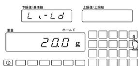
重量表示画面において、設定したい下限幅を数値キーで入力して、[下限セット
