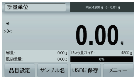
LFT を ON にした計量アプリケーションのメイン画面
