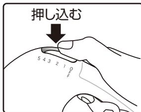
スピード切替スイッチをOFFの位置にし、図のように上から強く押しこめば外れます。
