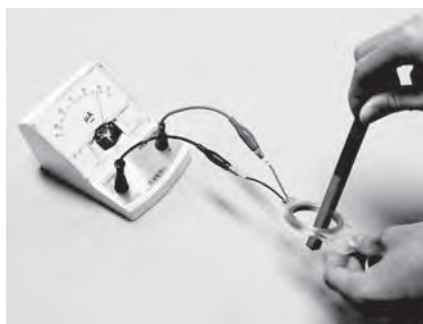
図 6 誘導電流の測定
