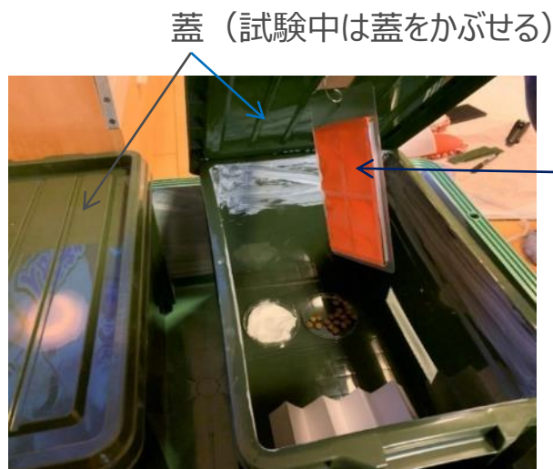
写真4. ピット設置の様子 (蓋裏に吊り下げ)
