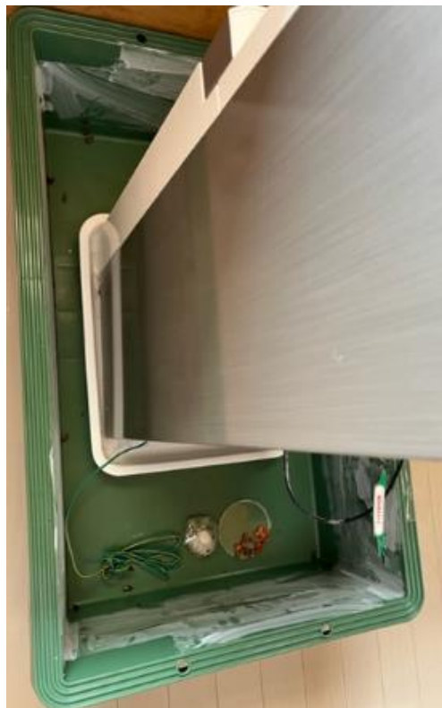
図2. 試験状況 (外容器にトレイAを置き、 その上に筐体を設置し観察)
