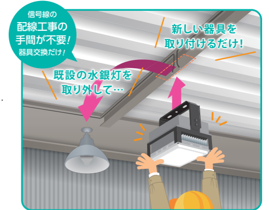
※LED化には簡単な工事が必要となります。
