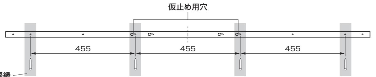
上記以外の間隔の野縁に取付ける場合、既存の穴は使用できません。下地の間隔に合わせてスライドレールの適当な位置にΦ4.5の穴を開けてください。(必要ねじ数量:4本~6本)
