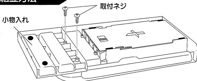
包丁トレーをご使用になる引出しの奥行き寸を実測し、下図を参考に小物入れの位置を調整し、取付ネジでしっかり固定して下さい。
