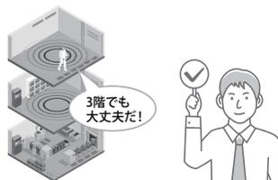
フロアごとの環境振動を計測し、装置の設置条件を満たしているかを確認。
