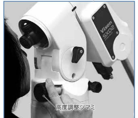
6 5で八分儀座 $\sigma$ 星( $\sigma$ Oct)を導入すると、 $\tau$ Oct、 $\chi$ Octの目盛付近にもそれぞれの星が近づきますので、極軸望遠鏡をのぞきながら、極軸望遠鏡(鏡筒部)を回して、スケール上にある $\tau$ Octおよび $\chi$ Octの所定位置に、それぞれ、八分儀座 $\tau$ 星、 $\chi$ 星が一番近くなるようにします。
