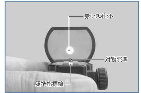
3 XYスポットファインダーの明るさ調節ツマミを右に回して赤い点(スポット)を点灯させます。
