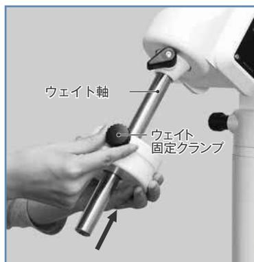
3 ウェイトを通す際は写真のようにウェイト固定クランプが上（ウェイト軸の付け根側）になるようにしてください。
