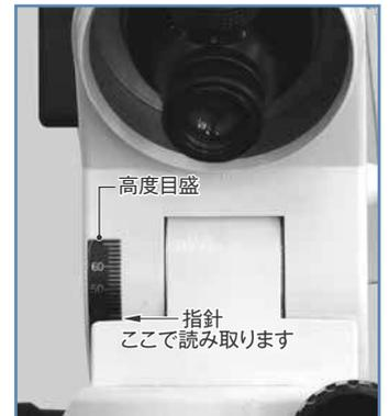
**7** 極軸望遠鏡をのぞきながら極軸望遠鏡(鏡筒部)を回し、1で確認した、実際の空におけるカシオペア座(北斗七星)の視位置と、スケール上に見えるカシオペア座(北斗七星)の向きが目分量で一致するようにしてください。
