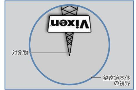
2 天体望遠鏡本体に低倍率となる接眼レンズを取付け、“まず天体望遠鏡をのぞいてみましょう”項目(P22参照)に従い遠距離にある目標物(鉄塔の先端など)を、天体望遠鏡本体をのぞきながら視野にとらえます。
