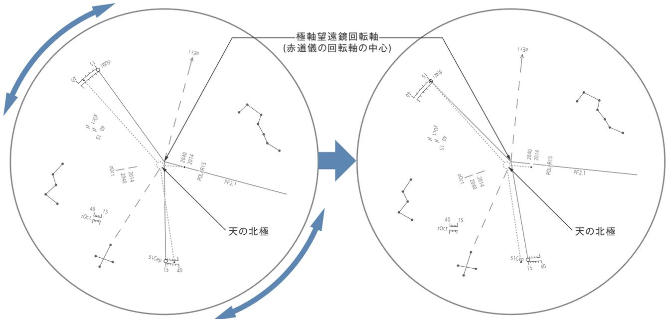
上図の「天の北極」と「極軸望遠鏡の回転中心」を合わせるのが極軸セッティングです。「天の北極」には目印が無い為に北極星とその近傍の星2つを利用して「天の北極」と「極軸望遠鏡の回転中心」を合わせます。最終目標は北極星は途切れた線の2014側ギリギリにありδUMiと51Cepはそれぞれ目盛の2014側の突き出た部分(図中の○中)に導入するのが目標です。(2014年の場合)
