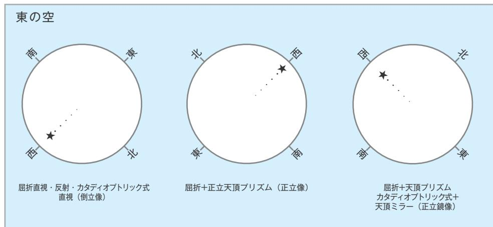
2と同様に赤道儀を恒星時駆動させながら十字線入り接眼レンズを用いて行います。また十字線入り接眼レンズのスケール1辺を西に流れる向きと平行にしてください。
