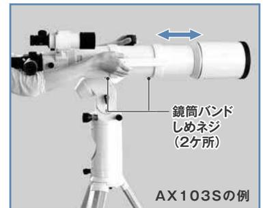
鏡筒を手でしっかりと支えながら鏡筒バンドの締めネジを少しゆるめます。
