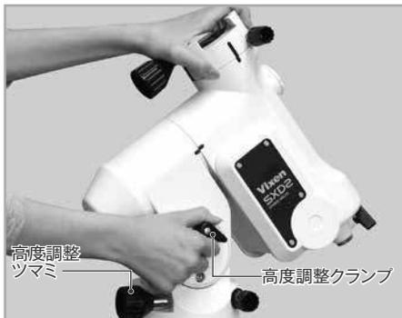
3 高度調整クランプの下に六角レンチ対応の固定ネジがありますので、この固定ネジを付属の六角レンチ(5mm)で取外します。
