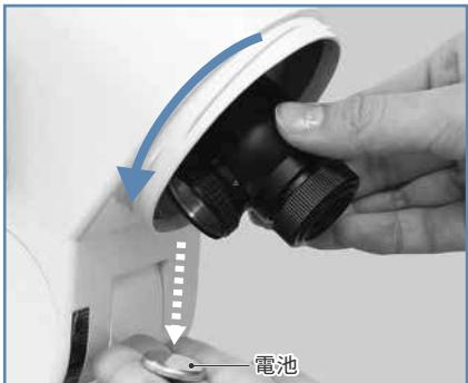
3 写真を参考に極軸望遠鏡を回してダイヤルが上向きとし、プラス・マイナス(+・-: 極性)に注意して新しい電池(CR2032×1個)を落とし込みます。電池室の奥になるほう(下側)がプラス(+)となります。
