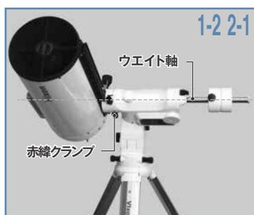
鏡筒を手でしっかりと支えながらアタッチメントレール（スライドバー）をしめつけている鏡筒固定ネジを少しゆるめます。①注意
