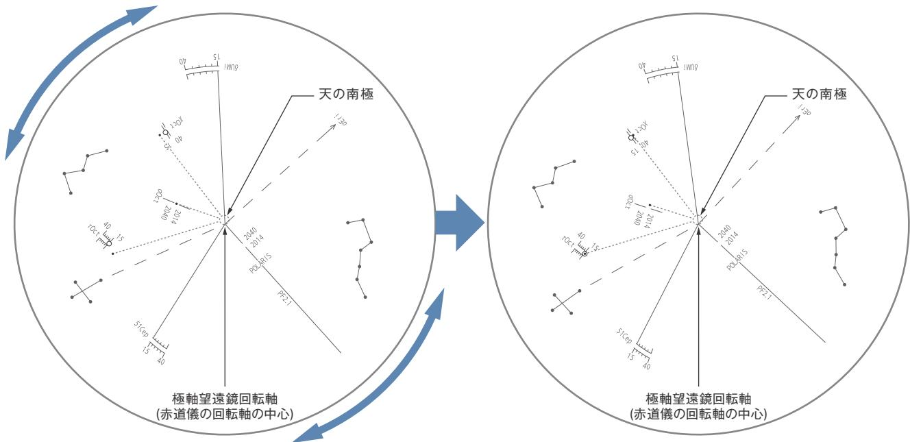
上図の「天の南極」と「極軸望遠鏡の回転中心」を合わせるのが極軸セッティングです。「天の南極」には目印が無い為に $\sigma$ Octと $\tau$ Oct、 $\chi$ Octを利用して「天の南極」と「極軸望遠鏡の回転中心」を合わせます。
