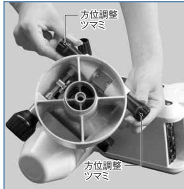
2 写真を参考に架台を三脚の上に置き、下から架台固定ボルト(下からのネジ)で固定します。取付ける際、三脚架台部分にある水平支点(ツノ)が方位調整ツマミのネジではさみ込まれる位置になるように配置してください。(2-1)、(2-2)
