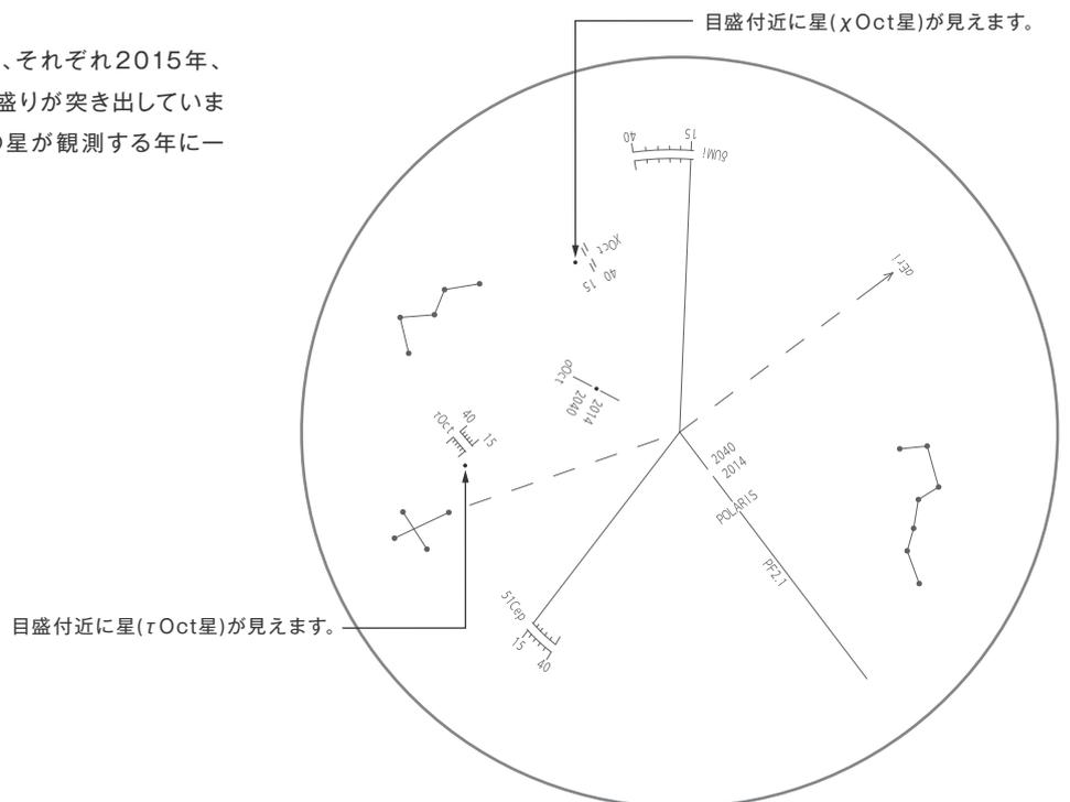
7 極軸望遠鏡をのぞきながら、方位調整ツマミと高度調整ツマミを回して、八分儀座 $\sigma$ 星の位置を「 $\sigma$ Oct」の2014、2040に挟まれた線分の切れ目に導入しますが、今度は目分量で観測年にできるだけ近くなる位置に導入してください。（図参照）
