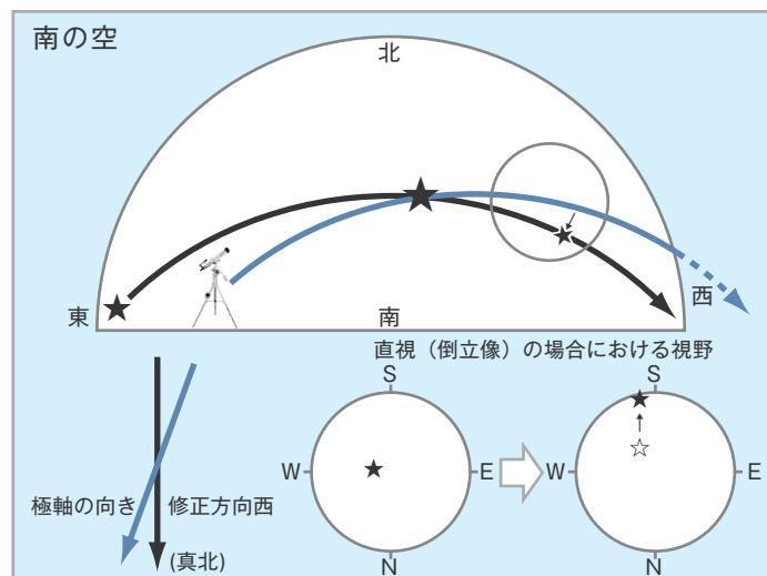
最終的に視野の中で星が南（視野の上）・北（視野の下）に移動しなくなった時点で方位調整の完了です。
