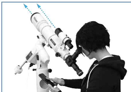
5-3 「アルタイル」が望遠鏡の視野中央に導入後、ALIGN X (Xには数字) をタップします。「アライメント アライメントしますか」ダイアログが表示されますので、はい をタップします。1点アライメントが完了するとともに、アプリの星図上で「アルタイル」と視野円の中心が一致します。また、自動導入後は必ずSCOPE MODE画面となります。
