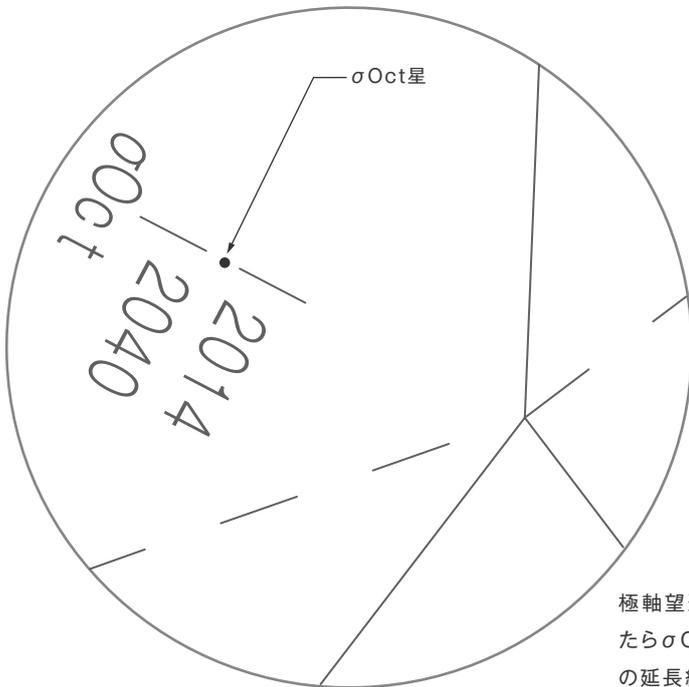
極軸望遠鏡のスケールの向きを合わせたら $\sigma$ Octを上図のようにおおよそ線の延長線上に導入します。
