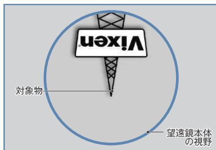
2 天体望遠鏡本体に低倍率となる接眼レンズを取り付け、“まず天体望遠鏡をのぞいてみましょう”項目（P22参照）に従い遠距離にある目標物（鉄塔の先端など）を、天体望遠鏡本体をのぞきながら視野にとらえます。
