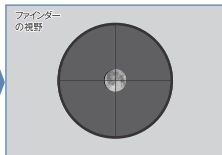
2 天体望遠鏡に低倍率の接眼レンズ(=mm数の大きな接眼レンズ)を取りつけてのぞき、フォーカスノブ(合焦ハンドル)を回してピントを合わせます。
