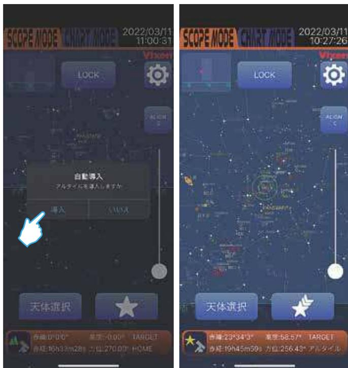
5 導入動作が完了するとスマートフォンの通知音/バイブレーションなどで通知されます。この時点で天体望遠鏡が目標天体(アルタイル)のおおよその方向に向きますが、天体望遠鏡の視野に必ずしも導入されるとは限りません。このため、以下の手順で修正します。
