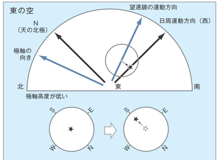
最終的に視野の中で星が南 (視野の左上)・北 (視野の右下) に移動しなくなった時点で高度調整の完了です。
