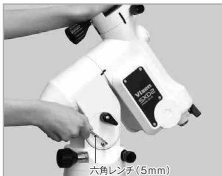
**4** 赤道儀本体を支えながら、高度調整クランプをゆるめます。
