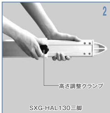
2 必要に応じて三脚の長さを調整してください。高さ調整クランプをゆるめるときと長さが調整できます。設定後はゆるまないようにしっかりとしめつけてください。
