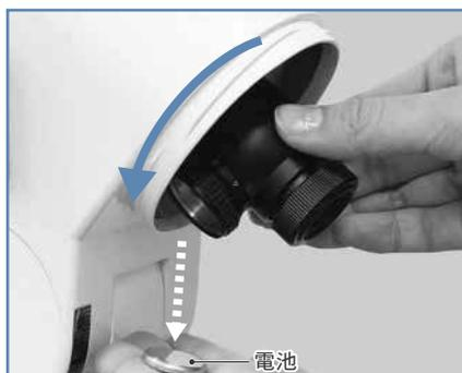
3 写真を参考に極軸望遠鏡を回してダイヤルが上向きとし、プラス・マイナス(+・-:極性)に注意して新しい電池(CR2032×1個)を落とします。電池室の奥になるほう(下側)がプラス(+)となります。
