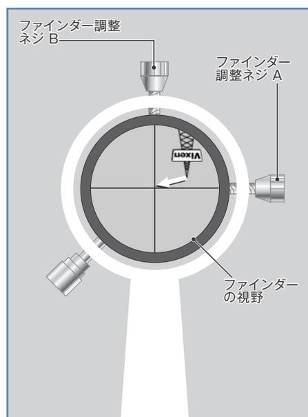
例：Aの調整ネジをゆるめ、Bのネジをゆるめると、電柱の先端は十字線の中央にきます。
