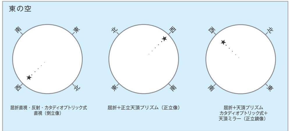
2と同様に赤道儀を恒星時駆動させながら十字線入り接眼レンズを用いて行います。また十字線入り接眼レンズのスケール1辺を西に流れる向きと平行にしてください。
