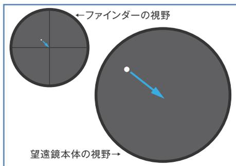
ファインダーの中心に「アルタイル」を導入後、望遠鏡には低倍率の接眼レンズ(mm数の大きいもの)を用いて視野に導入します。更に、高倍率の接眼レンズ(mm数の小さいもの)に交換して正確に視野の中央に導入しましょう。
