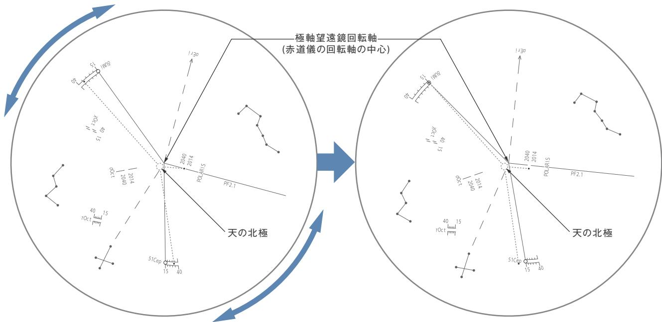
上図の「天の北極」と「極軸望遠鏡の回転中心」を合わせるのが極軸セッティングです。「天の北極」には目印が無い為に北極星とその近傍の星2つを利用して「天の北極」と「極軸望遠鏡の回転中心」を合わせます。最終目標は北極星は途切れた線の2014側ギリギリにありδUMiと51Cepはそれぞれ目盛の2014側の突き出た部分(図中の○中)に導入するのが目標です。
