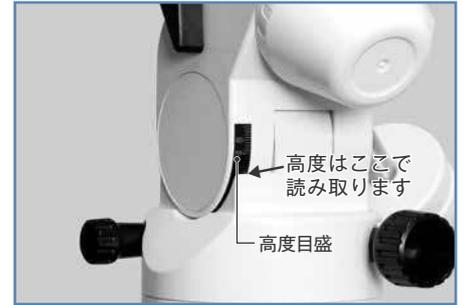
高度調整ツマミを回す時は、高度調整クランプをゆるめてから回してください。高度調整が終了したら高度調整クランプをしめてください。
