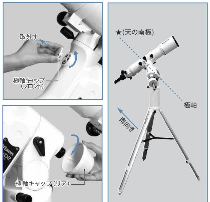
2 八分儀座が見える水平な固い場所を選び望遠鏡を設置し、極軸キャップを取り外します。方位磁針などを参考に、赤道儀の極軸がほぼ南向きになるように望遠鏡を設置します。また安定した設置とするため、架台が水平になるように三脚の長さを調節して設置してください。
