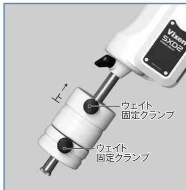
4 ウェイト固定クランプをしめて固定します。また安全のためウェイト脱落防止ネジをウェイト軸先端に再び取付けてください。ゆるまないようにしっかりと固定してください。
