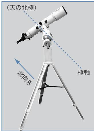
**3** 極軸キャップ(フロント・リア)を取外します。キャップはねじ込み式になっており、反時計方向に回すことで取外せます。
