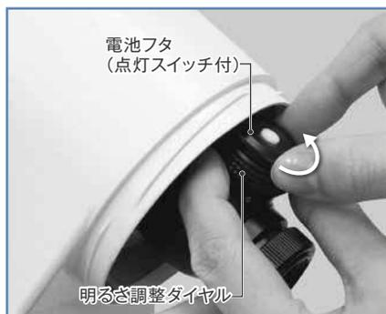
2 写真を参考に極軸望遠鏡を回してダイヤルが下向きになるようにすると古い電池が落下して取外せます。手でキャッチするなどして落とさないようにご注意ください。
