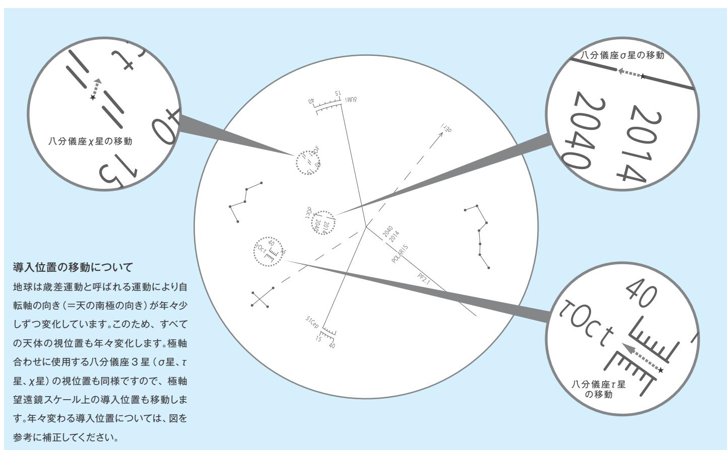
7 極軸望遠鏡をのぞきながら、方位調整ツマミと高度調整ツマミを回して、八分儀座 $\sigma$ 星の位置を「 $\sigma$ Oct」の2014、2040に挟まれた線分の切れ目に導入しますが、今度は目分量で観測年にできるだけ近くなる位置に導入してください。(図参照)
