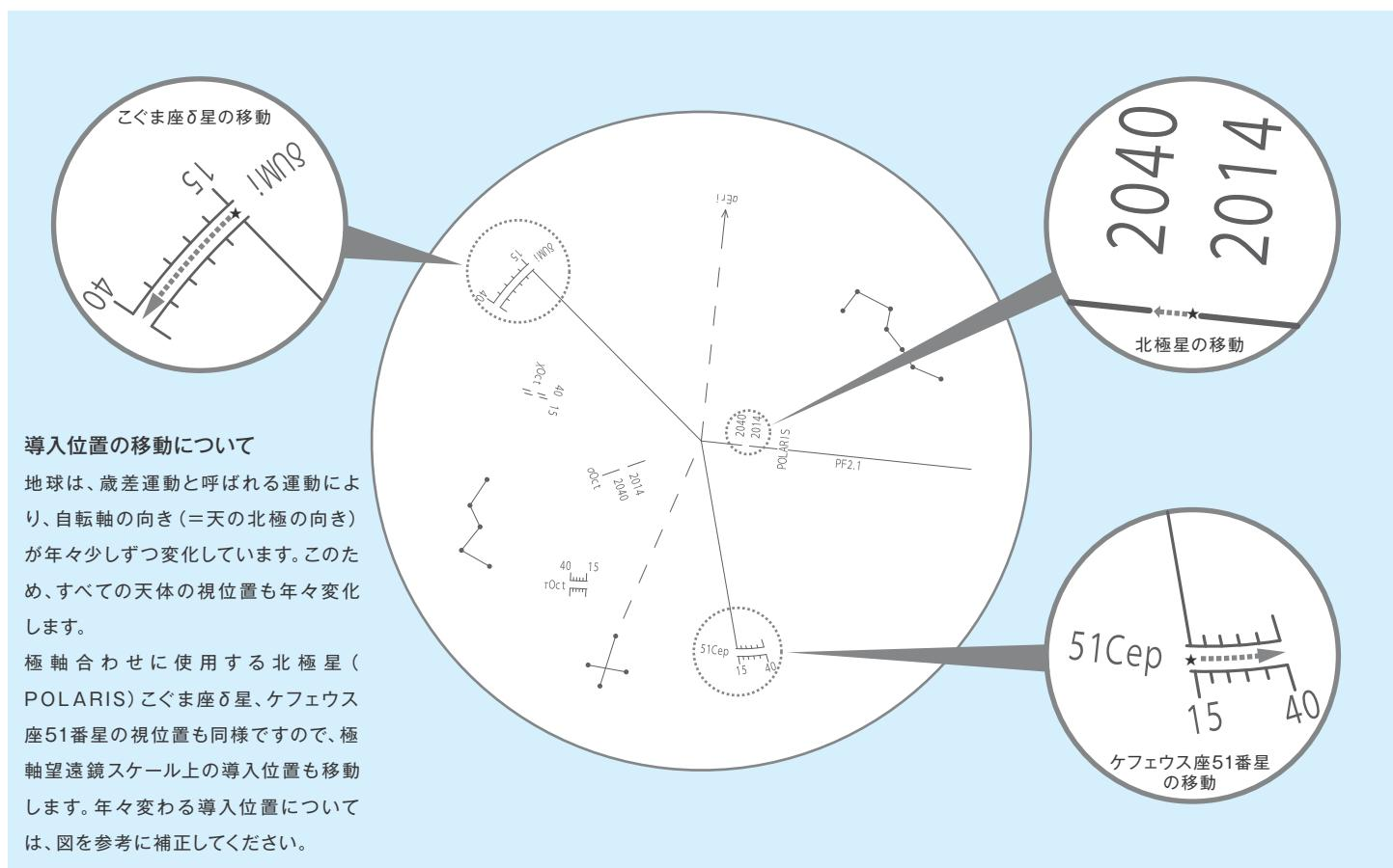
**12** 極軸望遠鏡をのぞきながら、方位調整ツマミと高度調整ツマミを回して、北極星の位置を「POLARIS」の2014、2040に挟まれた線分の切れ目に導入しますが、今度は自分で観測年にできるだけ近くなる位置に導入してください。
