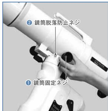
2 鏡筒のアタッチメントプレートWTを写真のように赤道機の筒受けの溝にはめます。
