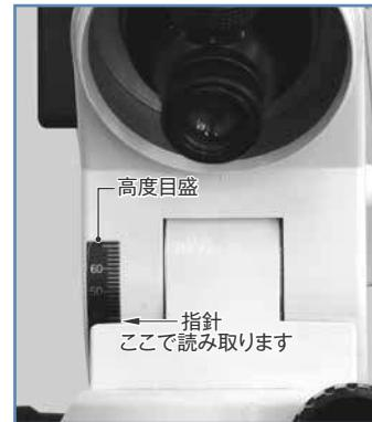
7 極軸望遠鏡をのぞきながら極軸望遠鏡(鏡筒部)を回し、1で確認した実際の空におけるカシオペア座(北斗七星)の視位置と、スケール上に見えるカシオペア座(北斗七星)の向きが目分量で一致するようにしてください。
