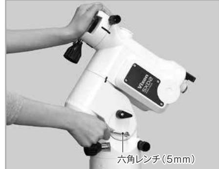
**7** 高度調整クランプを再度ゆるめ、使用する地域の緯度に合う位置まで高度調整ツマミで動かします。
