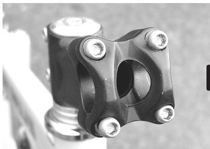
クランプボルト4本を緩めてクランプを外します。
