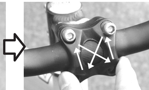
ハンドルを取り付け、4本のボルトを図の順番で仮止めします。
