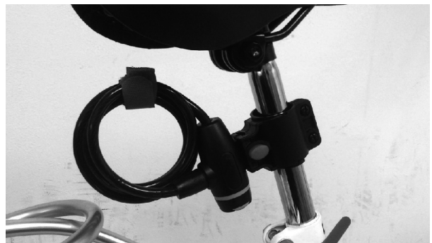
ホルダ付ワイヤーロックの取り付け参考図
