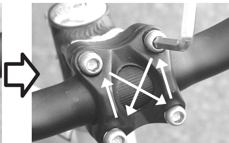
クランプとハンドルステムの隙間が上下均等になるように固定します。
