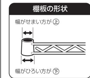
棚板を立てて、ボールを下側から固定部品取り付け位置まで差し込み固定します。
