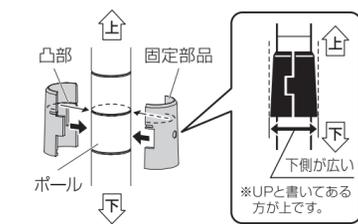
棚は1段ずつ下から順に組み立てます。固定部品を、上記ボールで決めた取り付け位置にセットします。このとき、固定部品内側の凸部がボールの溝に合うようにセットしてください。
