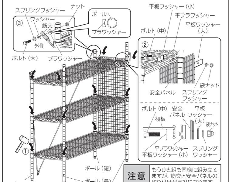
**注意** もうひとつ組も同様に組み立てますが、筋交と安全パネルの取り付けが反対になります。
