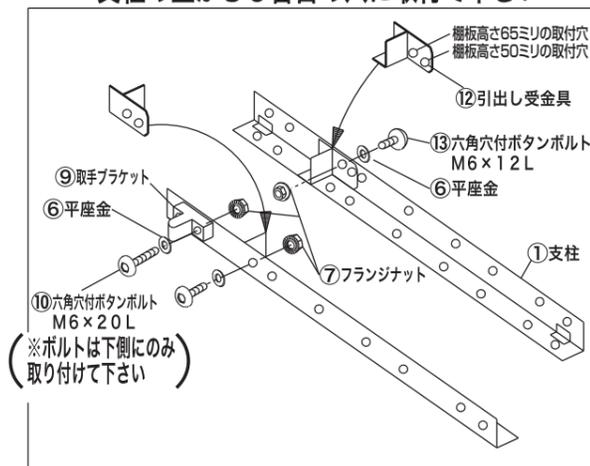
2 枕木の上に、支柱①を2本並べます。各棚板②・底棚③と支柱①を六角棒レンチでボルトを仮止めします。
