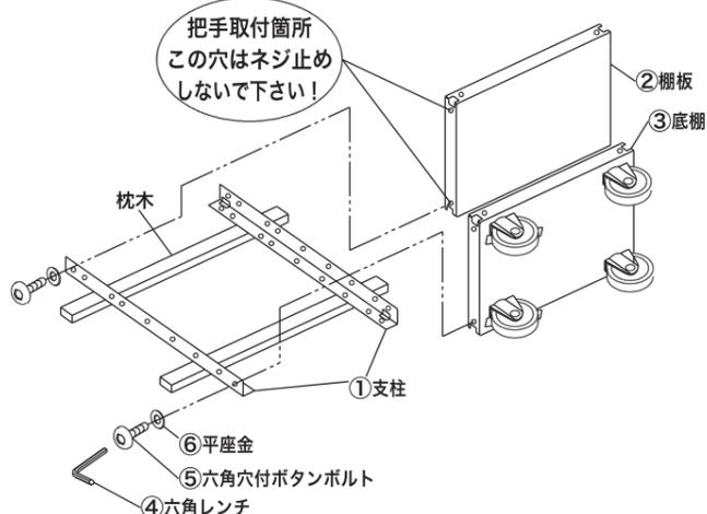
2 ①と同じ手順で反対側の支柱①を取付けます。また、ワゴンの最上部に取手を取付けます。最後に全てのネジを本締めします。
