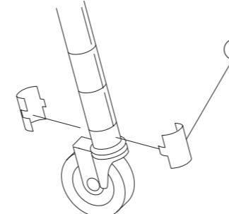
⑤最上段の棚板を取り付ける前にブッシュを任意の位置に取り付け、取手⑥をセットします。そして、最上段の棚板②（サカエシールが付いている方）セットしたのち樹脂ハンマー又は木槌で軽くたたき込んで下さい。
