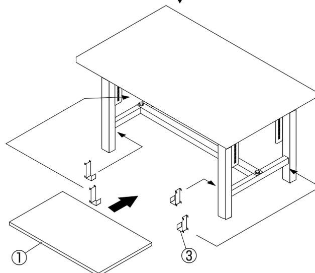
固定金具③を棚取付アタッチメント②の角穴に差し込みます。中棚①をセットします。
