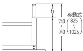
スライド脚には目盛りが刻印されています。0(最小)の所に合わせますとH740となります。200(最大)の所に合わせますとH940となります。※移動式の場合は、( )内H825(最小)~ H1025(最大)となります。目盛りが0~200の間で任意の高さに合わせてご使用できます。
