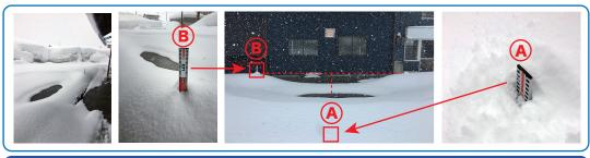
ヒーターの影響を受けていない部分の積雪は約1m (A地点) ヒーター中心から約4m付近の積雪約70cm(B地点) すり鉢状に雪が解けており、中心部分は約1m×4mの範囲で地面が露出。
