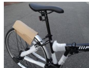
⑫サドルをお好みの高さで設定お願いいたします。※サドルポストを引上げ限界線より高くしないようにお願いします。
